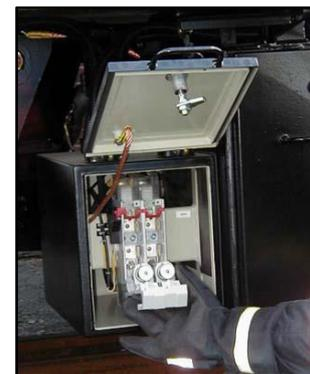
■ **Batteriespannung 110 V DC:**
