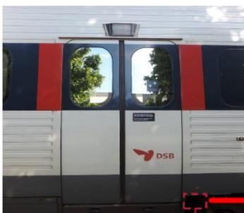
Seitlich neben den Einsteigtüren befindet sich im Bereich des Fahrgestells ein Schaltkasten, der mit einem Vierkantschloss verriegelt ist. Die beiden Knöpfe dienen dem pneumatischen Öffnen und Schließen der jeweiligen Tür. Gelb: Öffnen, Schwarz: Schließen
