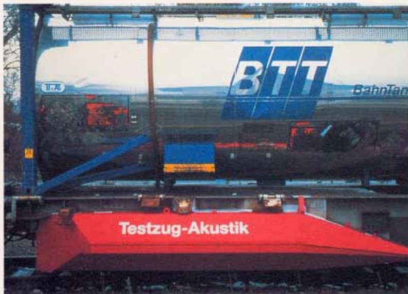
Schützende Schürze: Der Schall der rollenden Räder wird an diesem Versuchszug gleich an der Quelle eingefangen - Komponenten-Erprobung für den „Low Noise Train“
