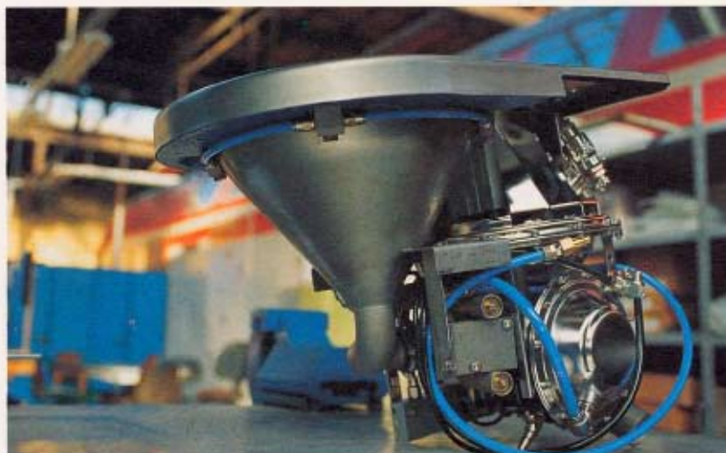
Technisch aufwendig, aber bald in allen Reisezugwagen selbstverständlich: Vakuum-Toilette
