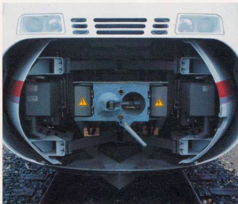
Klappe auf beim ICE 2: Über die automatische Kupplung können zwei Einheiten innerhalb von Sekunden verbunden oder getrennt werden - „Flügelzüge“ als flexible Antwort auf Kunden- wünsche
