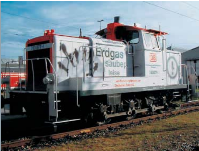
Die erste mit flüssigem Erdgas betriebene Lok des Forschungs- und Technologie-Zentrums der DB AG ging 2001 in München an den Start.
