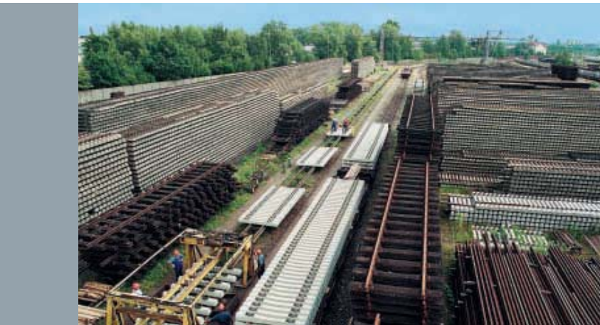
Bahnschwellen haben zwei Leben: Rundum erneuert werden Sie im zweiten Zyklus für weniger befahrene Strecken genutzt.
