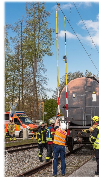
Abbildung 10: Für die Sicherstellung der Bahnerdung ist der Notfallmanager verantwortlich
