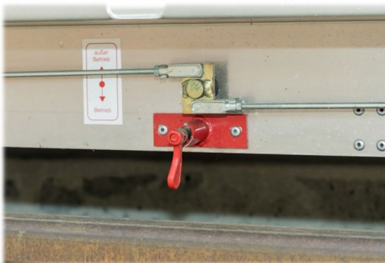
Abbildung 20: Ausschalten der Bremse
