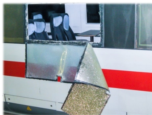
Abbildung 19: Notausstiegsfenster lassen sich nach außen wegdrücken
