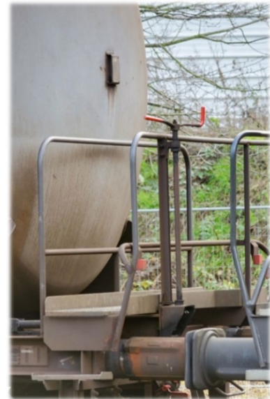
Abbildung 21: Feststellbrems-einrichtungen auf der Pufferbrücke
