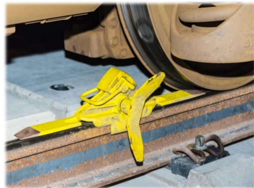
Abbildung 23: Radvorleger werden auf der Schiene befestigt
