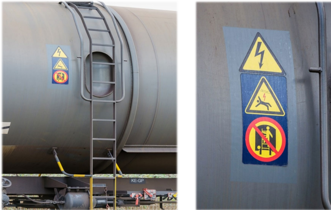
Abbildung 3: Warnhinweis Oberleitung an Fahrzeugen
