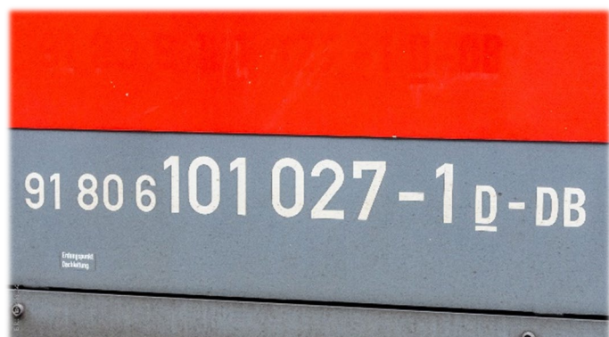
Abbildung 17: Zwölfstellige Fahrzeugnummer mit Baureihe
