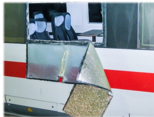
Abbildung 20: Notausstiegsfenster lassen sich nach außen wegdrücken
