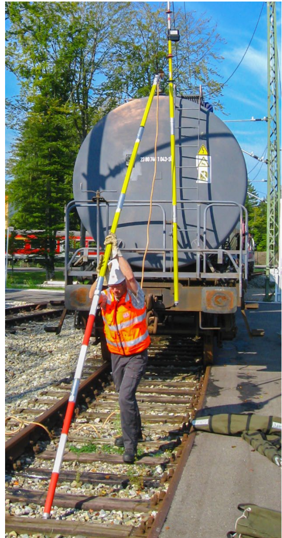
Abbildung 10: Für die Sicherstellung der Bahnerdung ist der Notfallmanager verantwortlich
