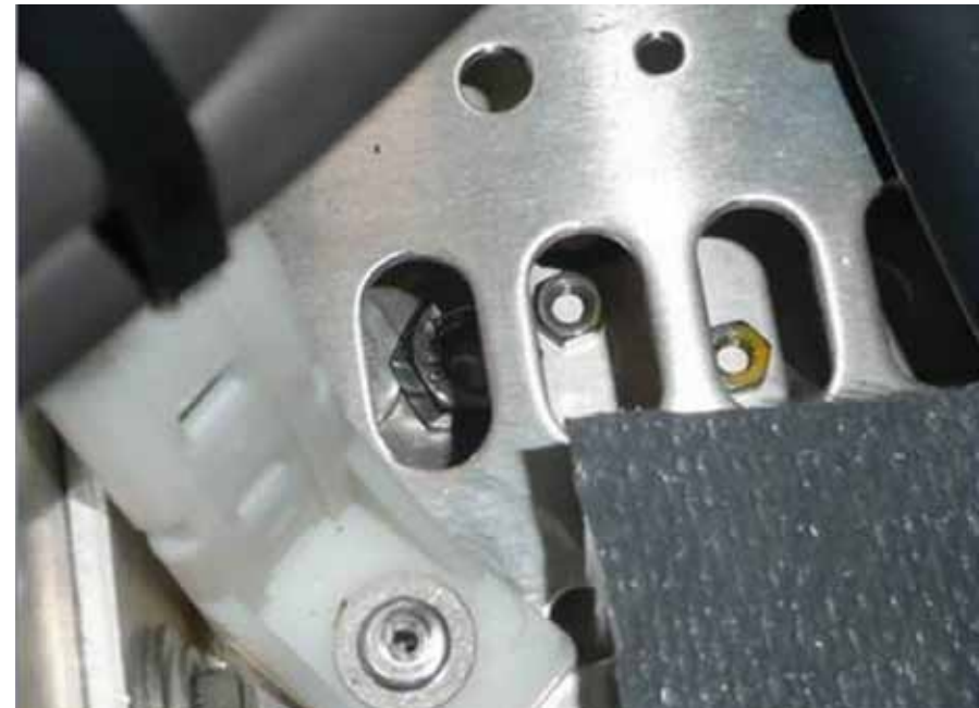
B12 STROMRICHTER_metalli sehe Fremdkörper im Umrichter
