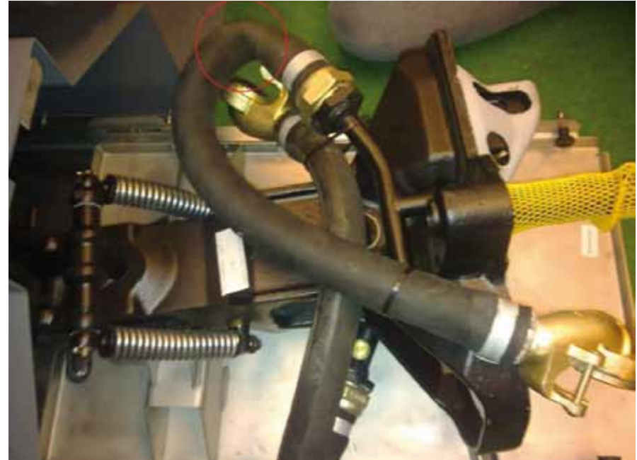
B10 DREHGESTELL_Luftschlauch geknickt_ Querschnittsverminderung
