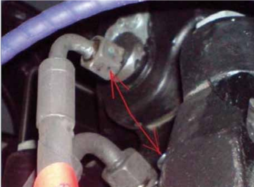
B9 DREHGESTELL_Luftanschluss Bremszylinder nicht angeschlossen
