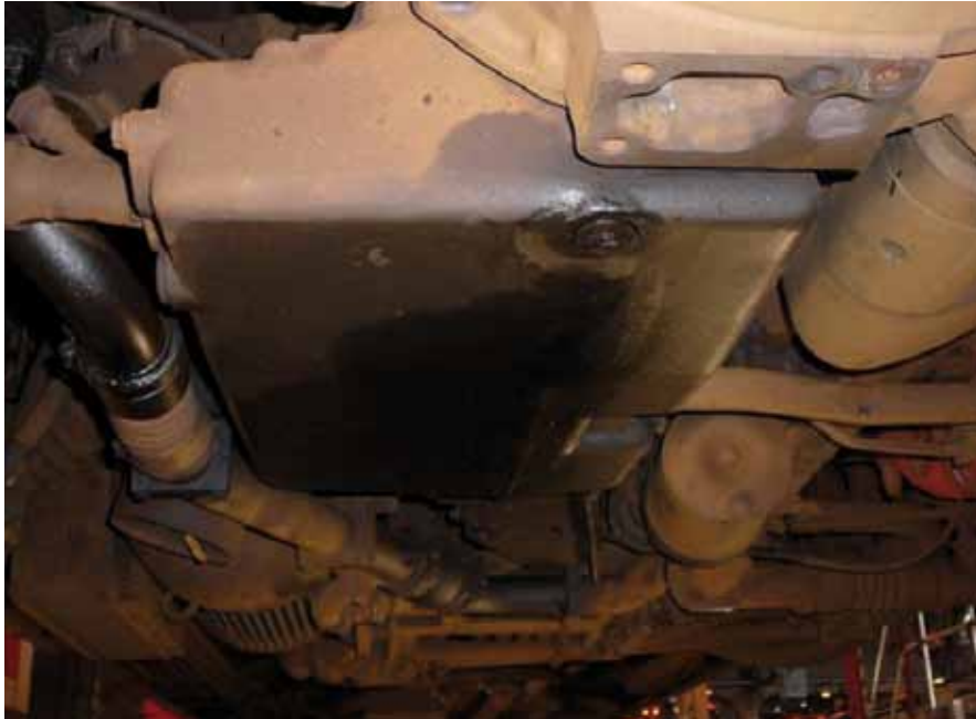
B21 ÜG_ROHR_DICHT_Undichtigkeit Ölwanne
