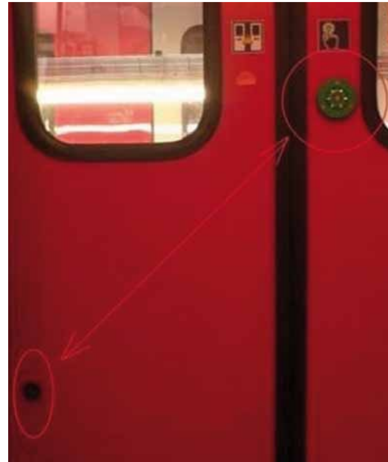
B16 ÜG_FUNKTION_Tür mechanisch aber nicht elektrisch verriegelt
