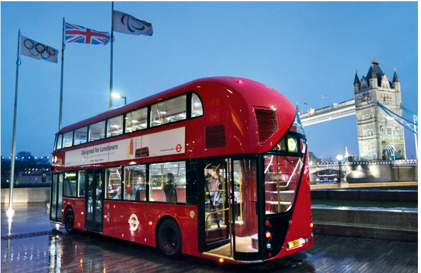
Der „New Bus for London“ fährt mit einem dieselelektrischen Hybridantrieb.
