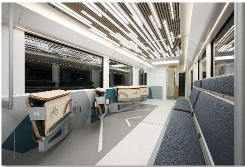
Die 30°-Drehung der Räder an der Außenwand des Zuges erweitert die Kapazitäten.
