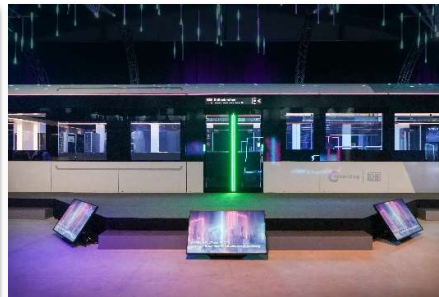
Exterior Nebenverkehrszeit: Entsprechende LED-Symbole sind ausgeblendet und ermöglichen freie Sicht nach draußen
